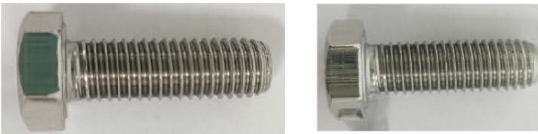
图4 硫酸和硝酸浸泡96h外观图
